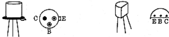
Abb.2 Zwei unterschiedliche Transistorgehäuseformen
